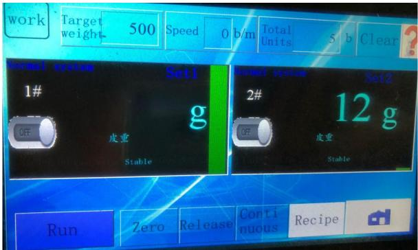
如上图所示,每个秤斗在运行中能将实时称量结果在相应秤号右侧显示。而左上角显示的则是此时秤所在的状态,如系统正常,正在下料或者
