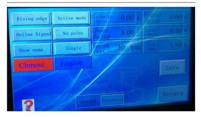
通过密码输入即可进入此系统参数设置页面,在此页面可对相关参数进行设置。
